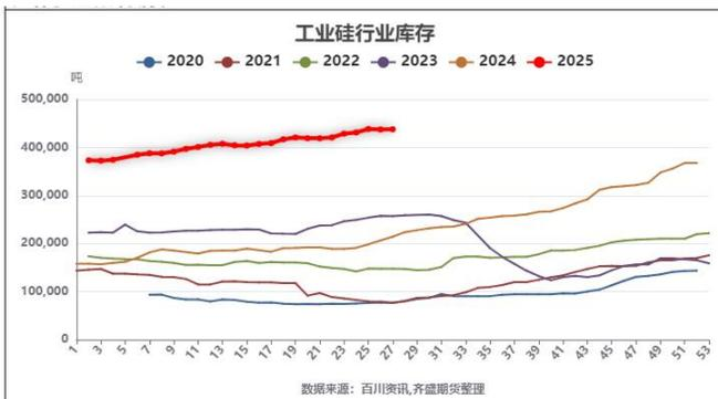
上周新疆地区停炉3台, 云南地区开炉13台, 四川地区开炉3台, 工业硅供给小幅回落。行业库存较上周有所下降, 工业硅行业库存43.79万吨。
